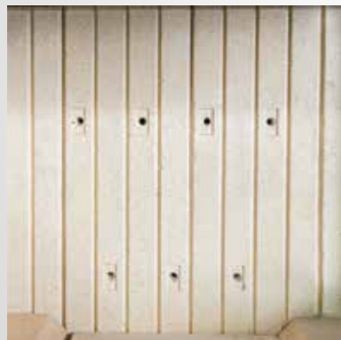
Komora spalania z dopalaniem wtórnym.
